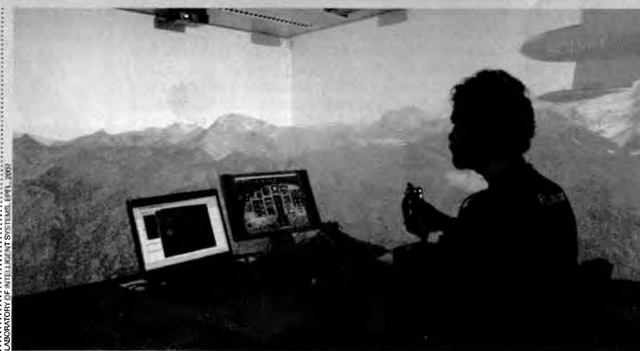
Un simulateur de vol est utilisé pour tester le prototype de l'interface de communication entre le futur avion solaire et son pilote.
